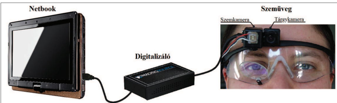
4. ábra Az IKTIVision rendszer felépítése
