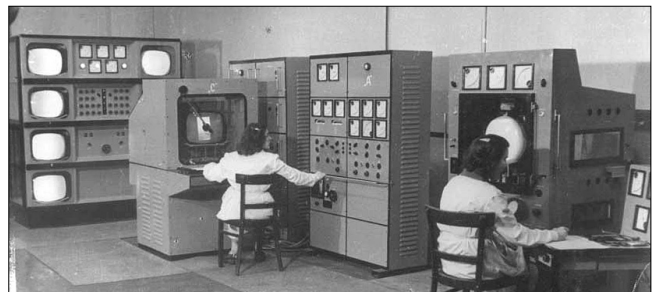
A TV-képcsővek mérőállomása a váci képcsőgyárban
