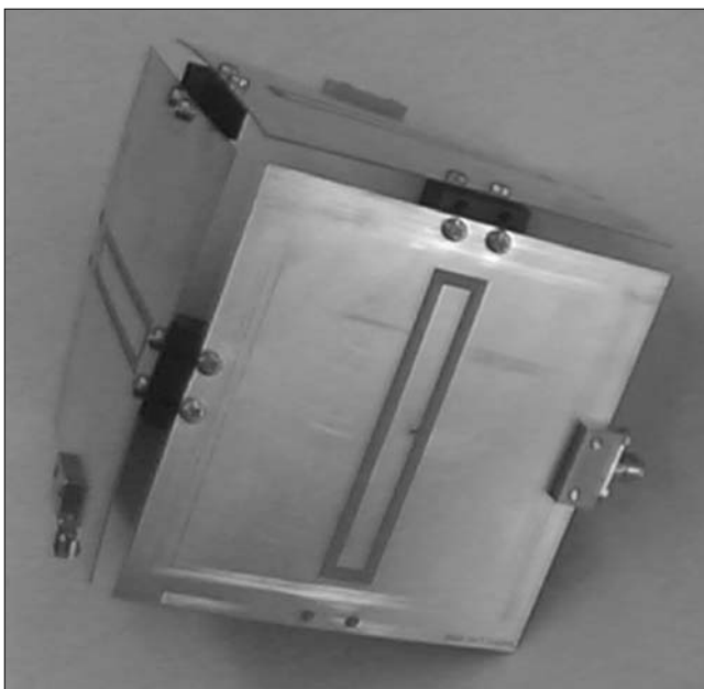
5. ábra 3 lapközép-antennás rendszer
