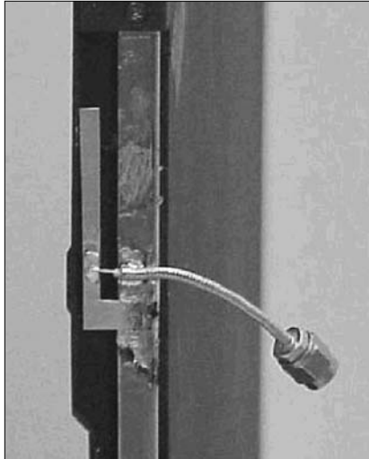
15. ábra A földlemezhez képest derékszögű elhelyezésű IFA antenna
