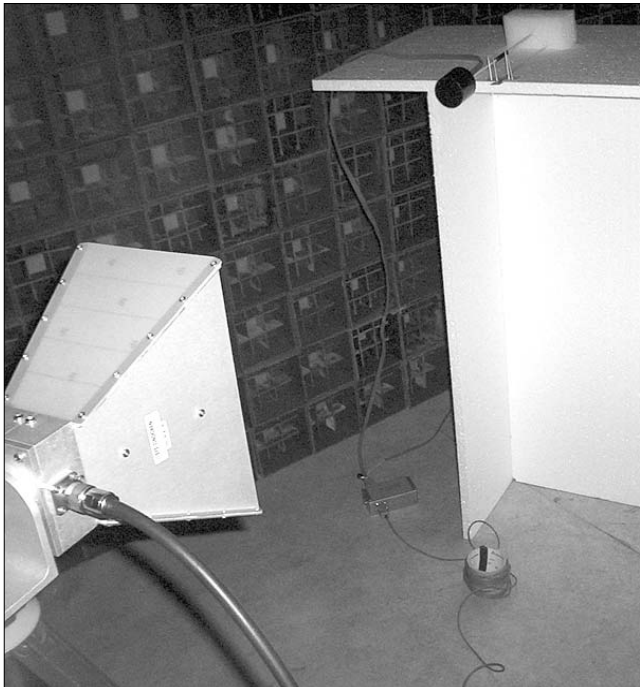
6. ábra Szonda érzékenysége mérése az MFA reflexiómentes helységében kalibrált antennával.
