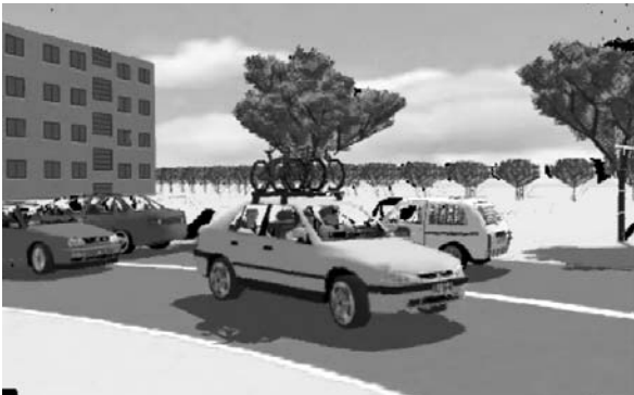
4.3. ábra A két szomszédos referenciaképről való eredő becslés (PSNR=33.45 dB). A jobb oldali nagy fa felett és mellett, valamint a fehér autó előtt képpontok hiányoznak.
