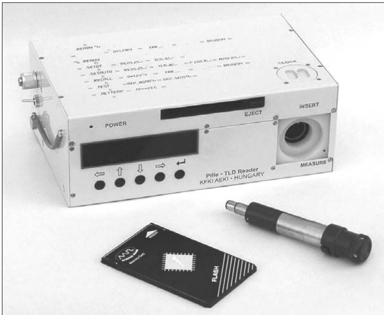
1-2. ábra Az ISS-en repülő Pille rendszer elemei (kiolvasó, dózismérő kulcs, memóriakártya) és a kiolvasó belsejének képe
