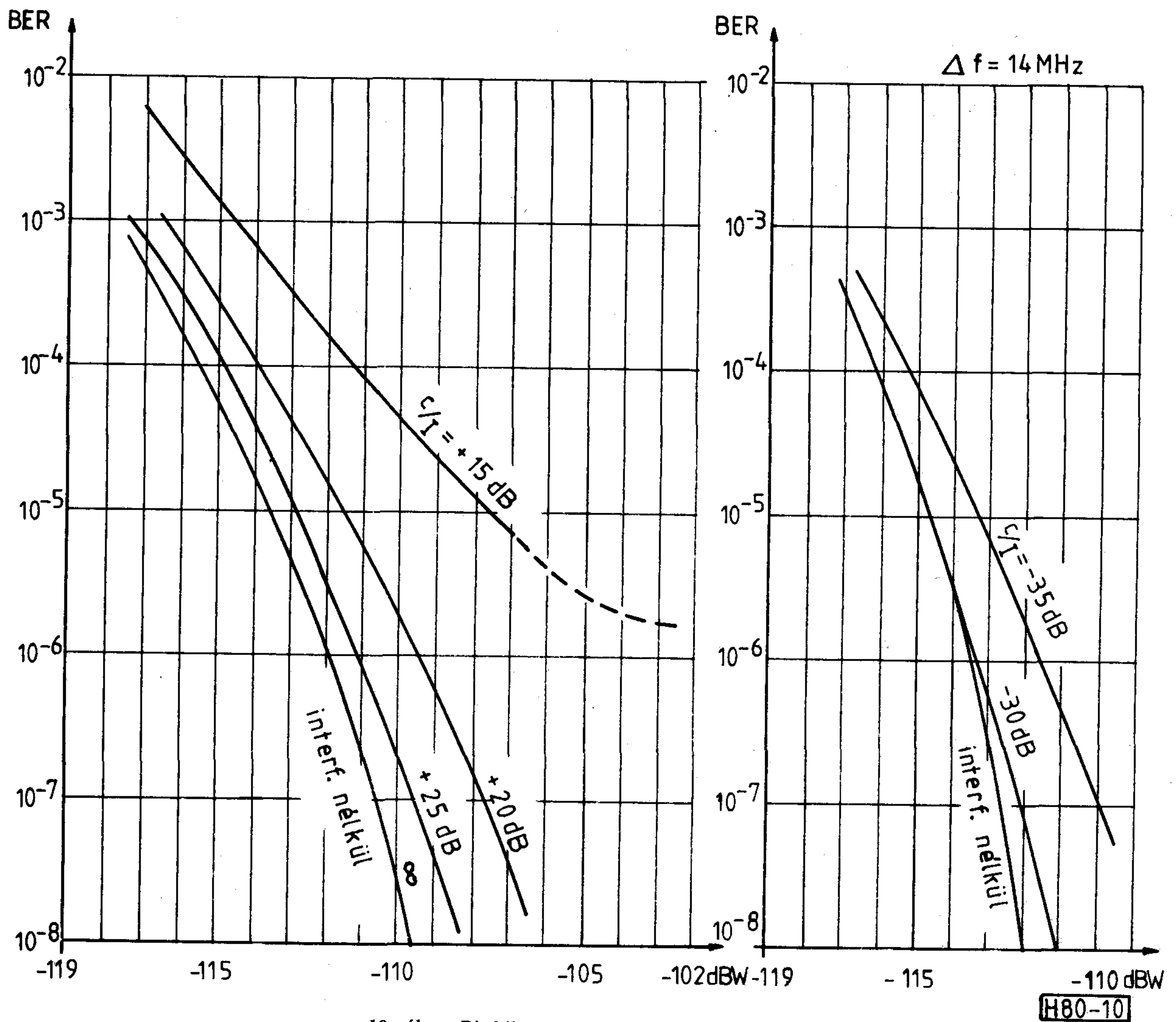
10. ábra. Bit hibaarány karakterisztika a) Sávbaeső interferencia esetén; b) szomszédos interferencia esetén
