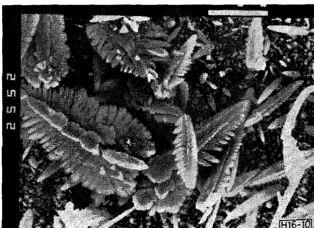
10. ábra. Dendrites szerkezet kialakulása 0,45 g/l Co-tartalom esetében 25 °C-on. 4 perces leválasztáskor 450 \text{A}/\text{m}^2 áramsűrűség mellett. SEM 2000×
