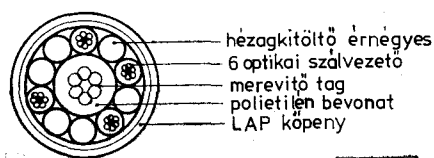
7. ábra. Az NTT 24 szálvezetőt tartalmazó optikai kábele Kawasaki helyi hálózatában
