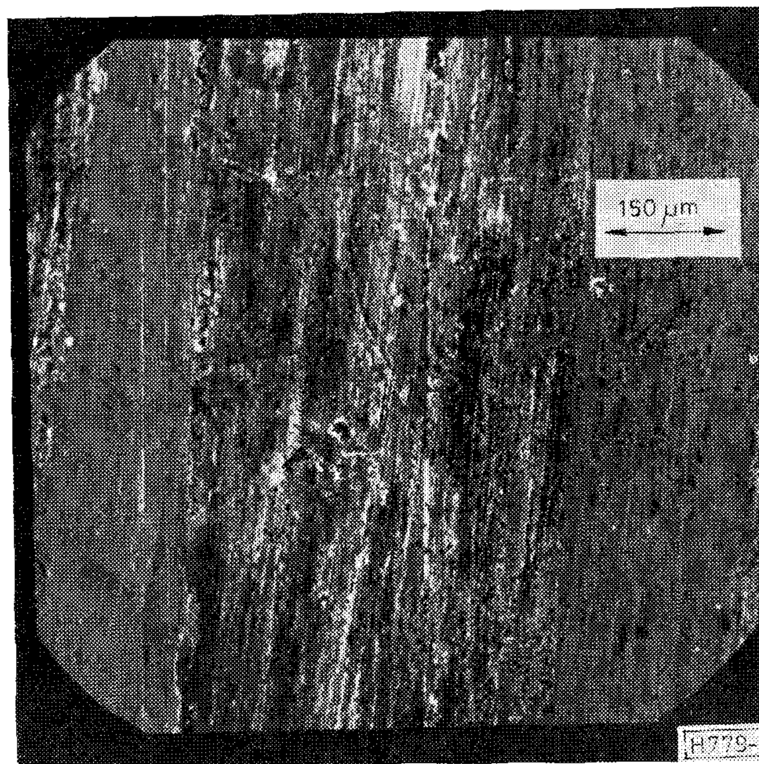
4. ábra. A tényleges érintkezési helyeken sávokban megjelenő, korróziós termékekből álló felületi rétegek mint amilyen az itt látható is (NYÁK papucs felület 2 év üzemidő után), eleinte még tisztítással eltávolíthatók (SEM, SEI, 25 kV).
