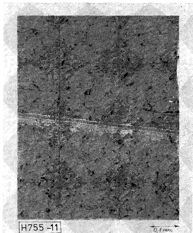
11. ábra. FREON TF-fel zsirtalanított aranybevonat fénymikroszkópos képe: 100 koptatási menet (1,0 N terhelés) utáni fotó
