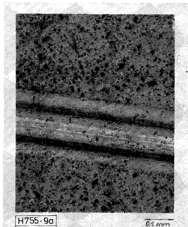
9. ábra. Kenőzsírral (BA 45 Grease Medium) végzett kopásvizsgálattal kapott nyomról készült fénymikroszkópos fotók (100 menet, 1,0 N):
