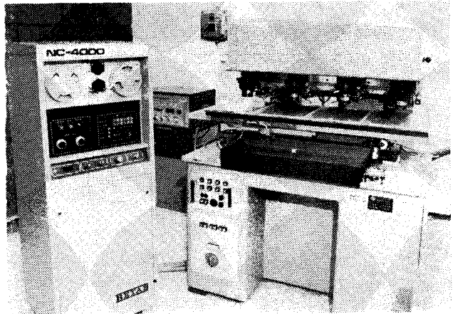
A lyukszalag vezérlésű, négyorsós automata lapfűrő gép, amely a nyomtatott huzalozású lapok furatait készíti el (4. ábra).
