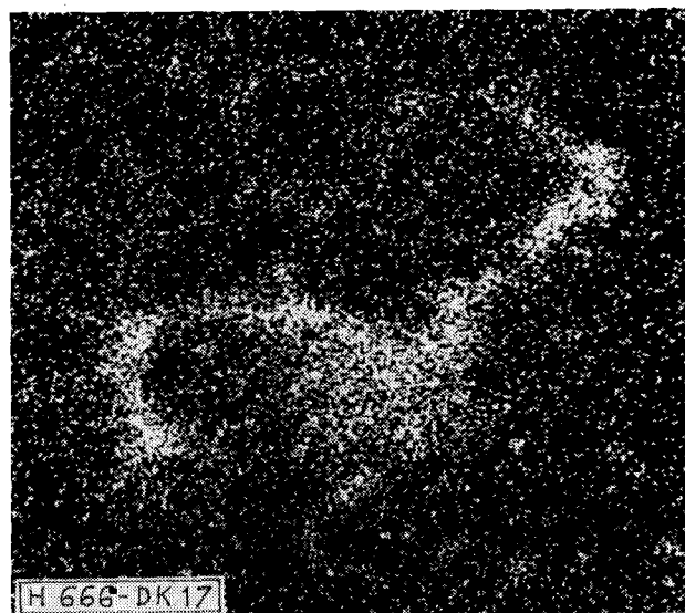
17. ábra. Aranyozott minták ezüstön 21 nap 15 \text{ cm}^3/\text{m}^3 \text{ H}_2\text{S} 75% rel. nedv. AgL \alpha -kép (ezüst), gyorsítófesz. 20 kV
