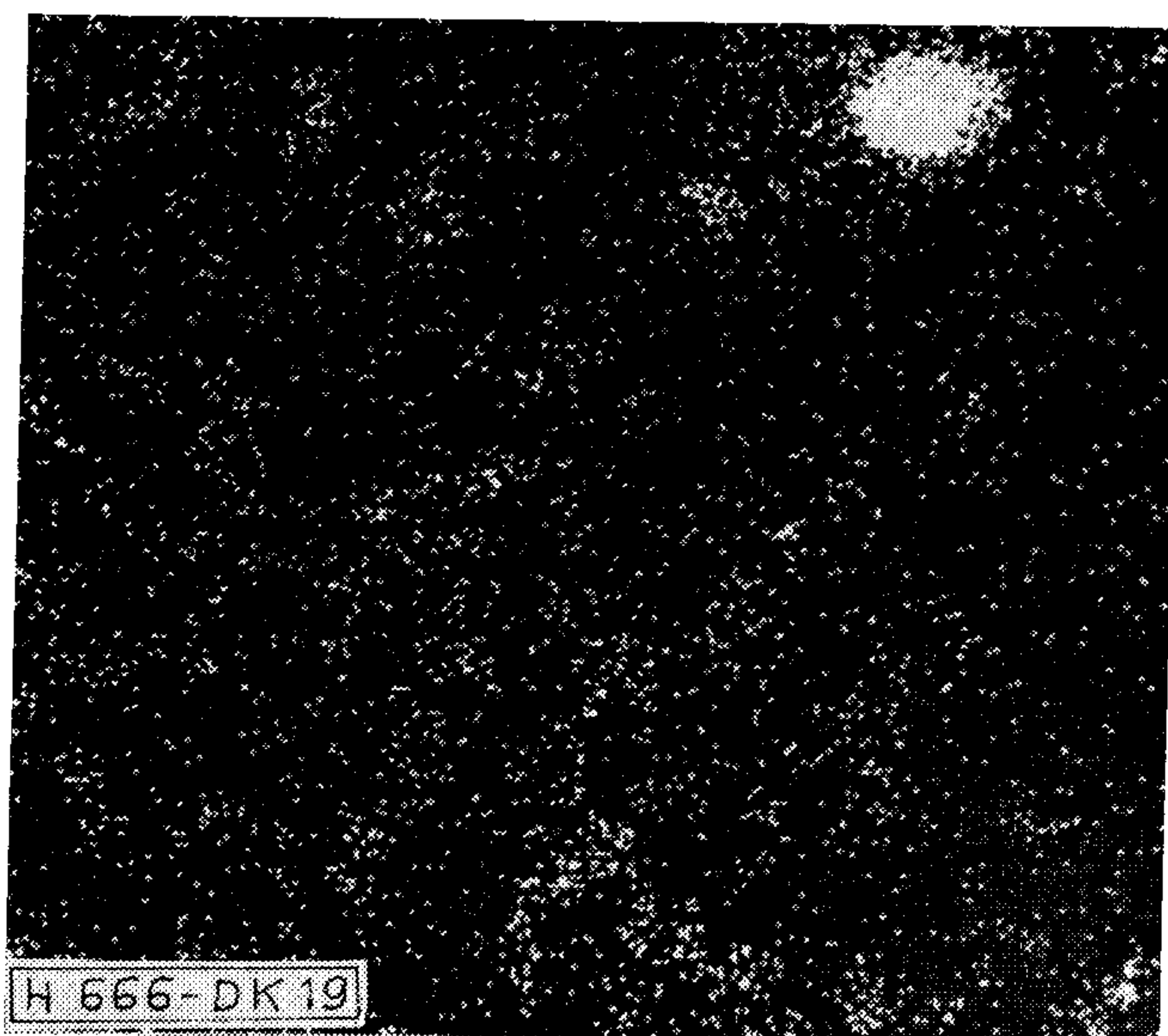
19. ábra. Aranyozott minták ezüstön 21 nap 15 \text{ cm}^3/\text{m}^3 \text{ H}_2\text{S} 75% rel. nedv. ClK \alpha -kép (klór), gyorsítófesz. 20 kV
