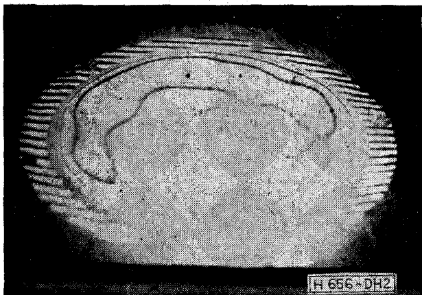
2. ábra. Szabványos 3 inch átmérőjű Si szelet síkság topogramja
