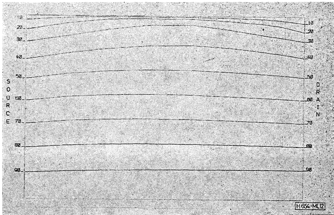
12. ábra. Az áramcsatorna alakja ( V_G = -5 V, V_D = -7,5 V, r. csat.)
