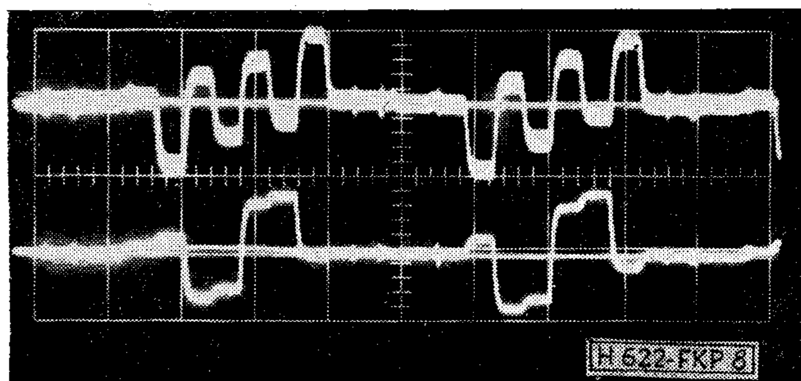
8. ábra. Demodulált B-Y és R-Y jelek idődiagramjai
