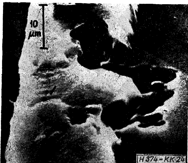
24. ábra. Nagyméretű porszem okozta óriási túlyuk mentén a fémezés elvékonyodott és 3300 óra, 125^\circ\text{C} üzem után zárlatot okozott a túlyuk mentén bediffundáló Al, a helyi erős melegedés miatt (SEM)
