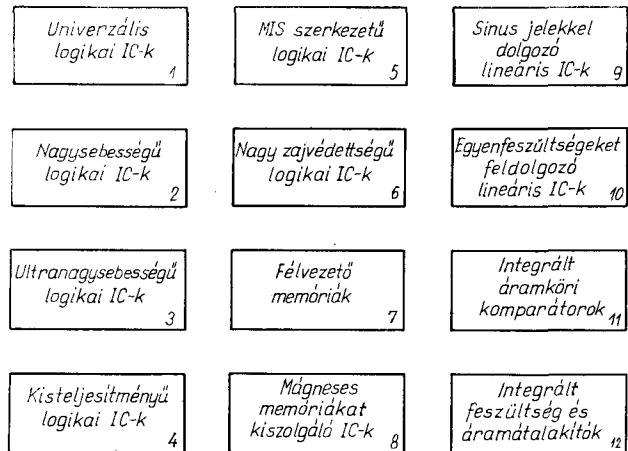
1. ábra. A félvezetőalapú integrált áramkörök osztályozása
